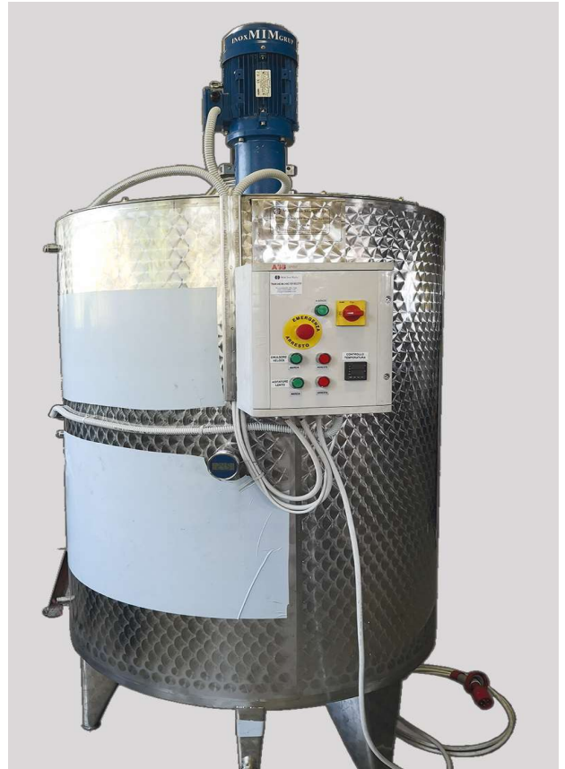
Mescolatore con doppia parete con resistenza per regolazione temperatura e Optional Turbo Agitatore
