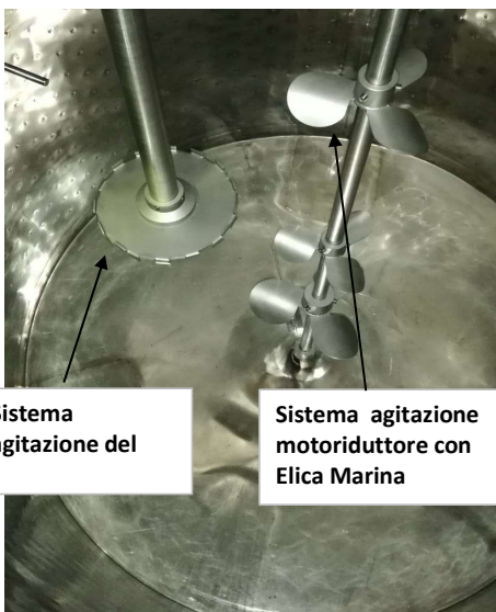
Sistema Agitazione, a destra per Motoriduttore con sistema ad Elica Marina e a Sinistra con agitatore Veloce 1800giri/min (Turboagitatore)
